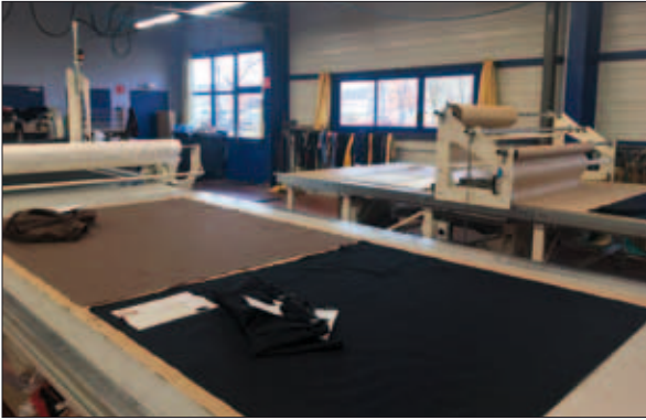
• Table de découpe textile par lame.
